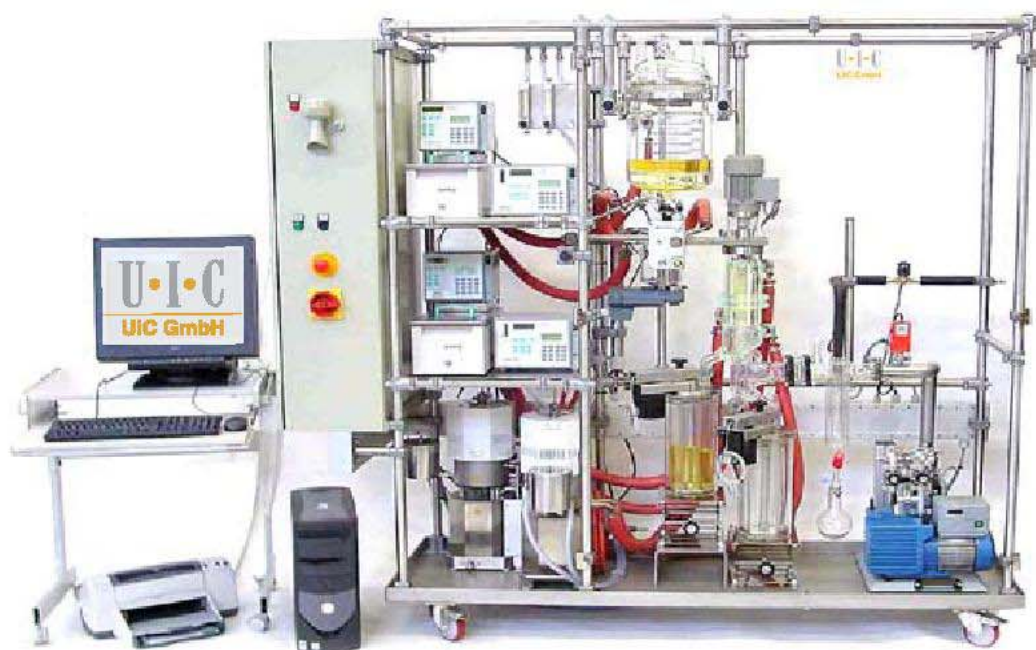
KDL 5 CADi, 计算机 辅助自动蒸馏装置
